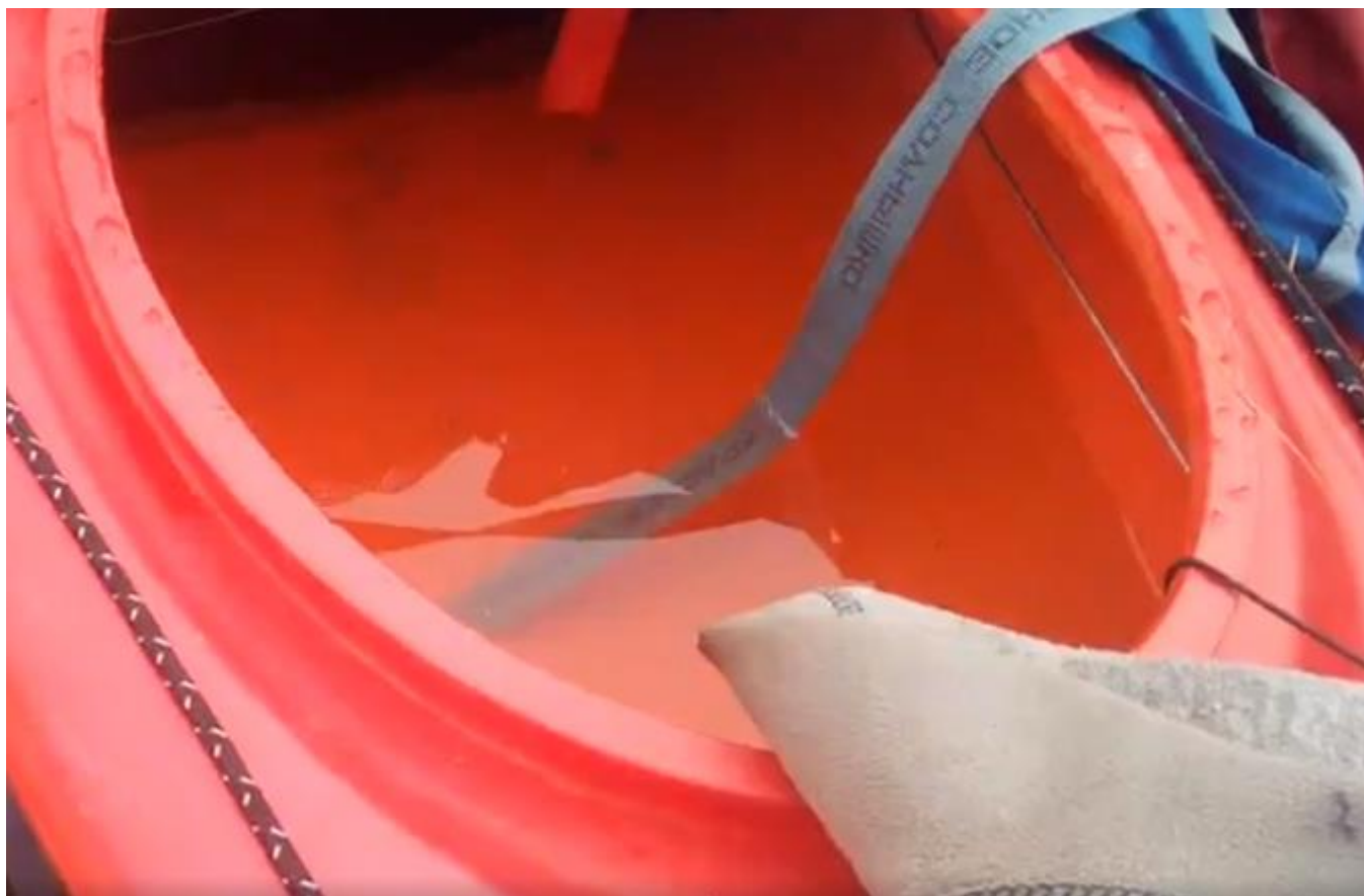
Вода в заднем отсеке двухместного каяка после шторма, необходима герметизация между тягами руля и корпусом.
