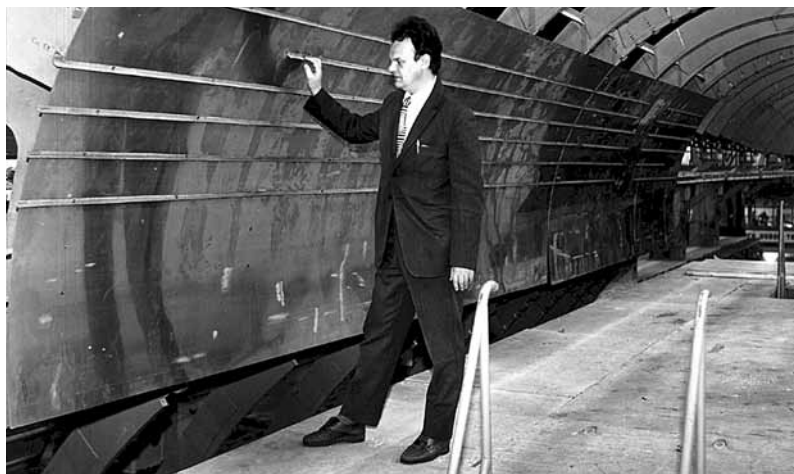
«Материализация духа». Ведущий конструктор Ан-124 В. И. Толмачев у первой панели фюзеляжа в сборочном стапеле первого «Руслана». 1979 г.
