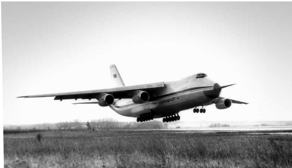
Ан-124 «Руслан», серийный номер «01-01», поднимается в первый испытательный полет, 24 декабря, 1982 г. На носовом обтекателе установлено контрольно-измерительное оборудование.
