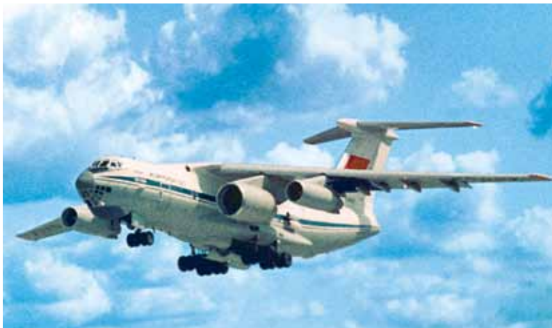
«Летающая лаборатория» – самолет Ил-76 с первым советским супердвигателем Д18Т. Октябрь 1981 г.
