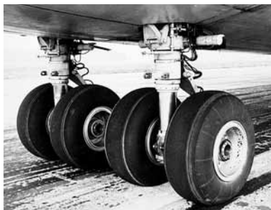
Принцип распределения нагрузок в действии. Переднее (слева) и основное шасси самолета Ан-124.
