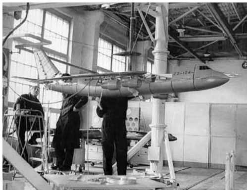
Подготовка и продувка моделей Ан-124 в аэродинамической трубе.
