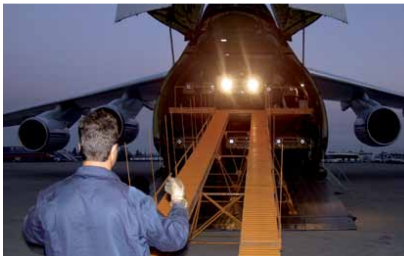
Перевозка автомобилей УАЗ из Ульяновска (Россия) в Адану (Турция) с использованием специального погрузочного комплекса для перевозки автомобилей в два яруса, 2004 г. Уникальная разработка инженеров «Волга-Днепр» позволяет перевозить до 55 автомобилей за один рейс.
