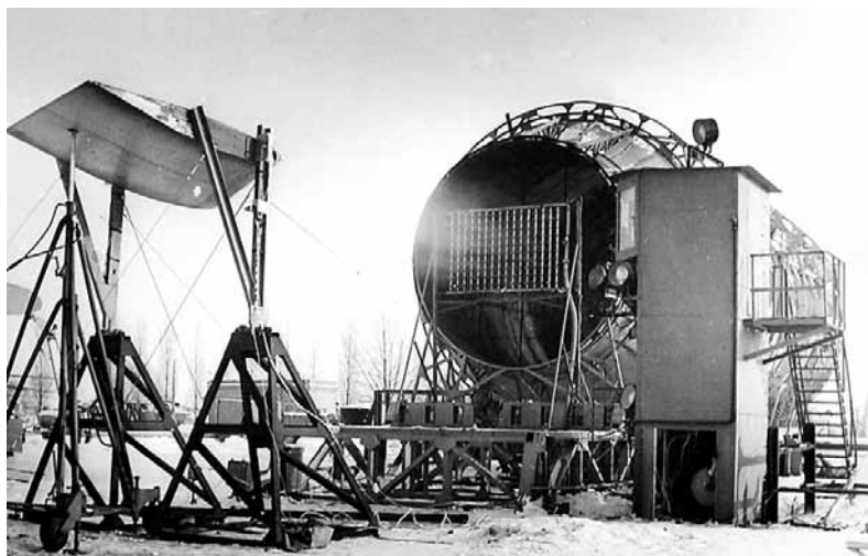
Испытания новой электроимпульсной противообледенительной системы в искусственном потоке воздуха с распылением воды. 1978 г.
