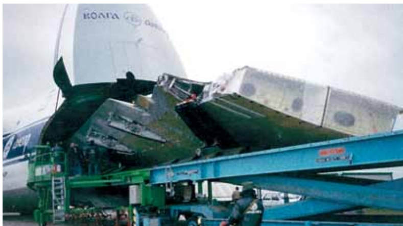
Экспериментальная загрузка крыльев европейских аэробусов А340 «Эрбас Индастри» в самолет Ан124. Тулуза (Франция). Май 1992 г.
