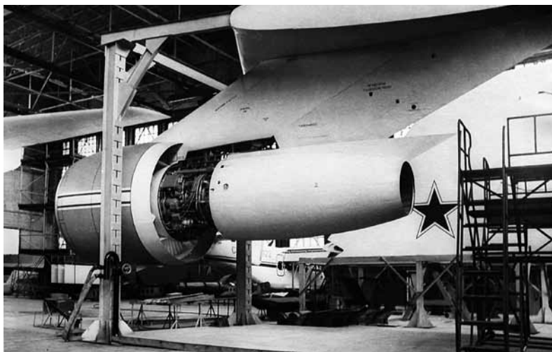
Фрагмент макета Ан-124 в натуральную величину с двигате- лем Д18.
