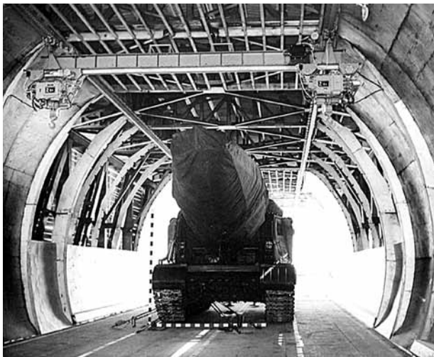
Стенд погрузки – выгрузки. По сквозному салону загружаемая колесная техника может дефилировать почти парадным маршем – как по струночке.
