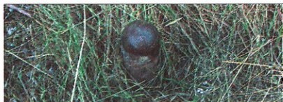
Центр геодезического пункта
