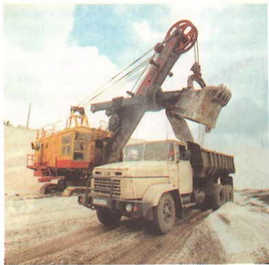
Рис. 17. Погрузка кварцевого песка в карьере
