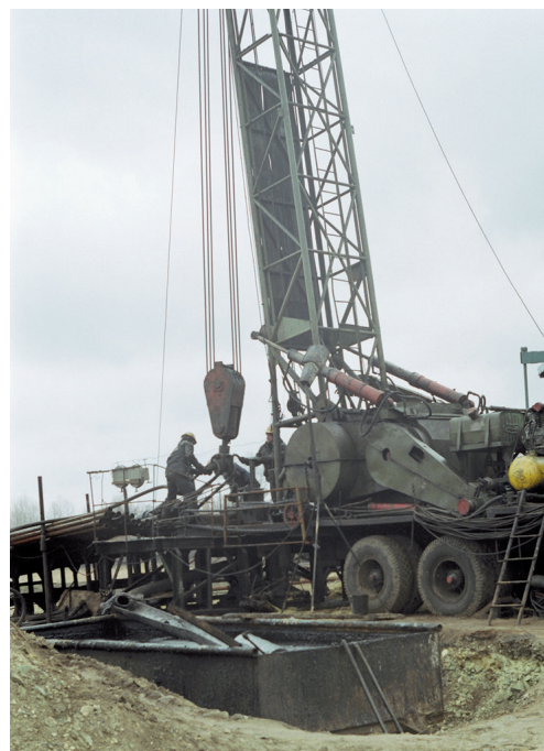
Агрегат для освоения и ремонта скважин грузоподъемностью 50 т. А-50-У. Ульяновская область, Новоспасский район
